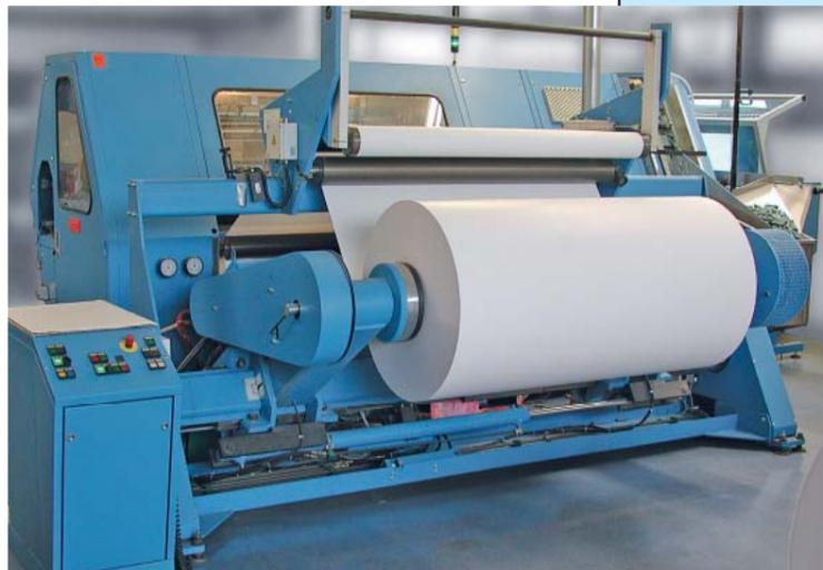
La dérouleuse centrale MPW300 est équipée d'un dévidoir sans arbre, dont les bras de levage chargent les bobines au sol. Cette opération de chargement peut également s'effectuer avec un pont roulant ou une table de levage.
