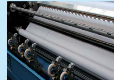
La bobineuse centrale non soutenue permet d'enrouler des matières à surface sensible. Les temps d'arrêt de la machine sont réduits en utilisant la bobineuse à touret qui porte 3 arbres de dévidoir. Le chargement de mandrin, l'enroulement et le déchargement du rouleau ont lieu simultanément et de façon totalement automatique.
