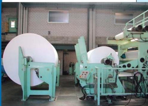
La machine est disponible avec un dévidoir à tambours usine, un dévidoir sans axe ou la combinaison des 2 systèmes. Le dérouleur standard est équipé de rails pour évacuer les tambours usine vides. Le chargement et le déchargement se font au moyen d'un pont roulant.
