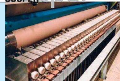
La section de coupe/refente est disponible pour couper par tangente ou par recouvrement. Même avec une coupe par recouvrement et un ajustement totalement automatique du couteau, chaque support de couteau supérieur est équipé de son propre entraînement de positionnement et peut placer la garniture du couteau inférieur adéquat au même instant.
