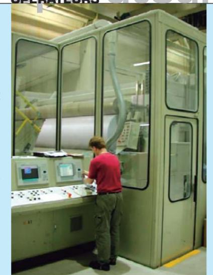
La console des opérateurs est équipée de deux ordinateurs en parallèle. L'opérateur dispose de menus clairs lui permettant une entrée facile des données de production.
