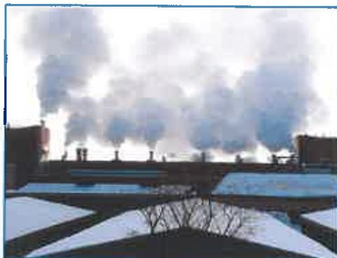
Le séchage du papier consomme plus de 70% de toute l'énergie nécessaire pour faire tourner une machine à papier. La partie sécherie d'une machine à papier nécessite de la vapeur à hauteur de 1000-1500kWh par tonne de papier produite. Aussi le coût de l'énergie pour une machine à papier est particulièrement élevé.
