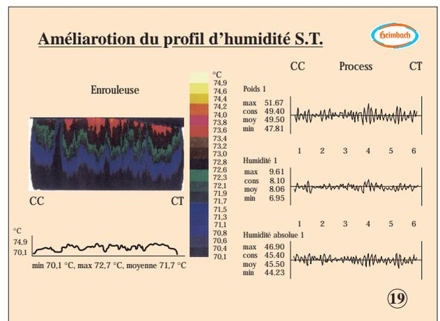
dans ces “vides” produisait une “isolation thermique” entre la vapeur vive et la paroi intérieure des cylindres. Par conséquent, ces “vides” étaient les causes des deux pics où la température de surface des cylindres était plus basse et, de ce fait, aussi responsables pour les deux “pointes humides”.
