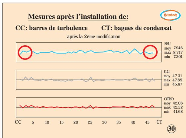
de chaque cylindre, ceci afin d'accroître l'épaisseur de l'anneau de condensats et ainsi de réduire la siccité dans cette zone. Les résultats des mesures correctives complémentaires sont illustrés sur le profil sens travers d'humidité de la fig. 30.
