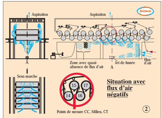
supérieure de la hotte sur le CC et le CT suite à la dépression (fig. 1), s'enrichit en humidité au fur et à mesure qu'il migre vers le milieu de la machine. Par la suite, l'humidité absolue de l'air augmente.
