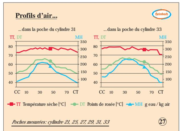
Comme déjà mentionné au paragraphe 1 au sujet des influences d'une bonne et mauvaise ventilation des poches..., dans ce cas pratique aussi, se sont produites des circulations d'air des bords vers le milieu suite à une mauvaise ventilation des poches. Des mesures des profils d'état de l'air (fig. 27) mettent à ce propos en évidence de forts taux d'humidité dans le milieu de la machine.
