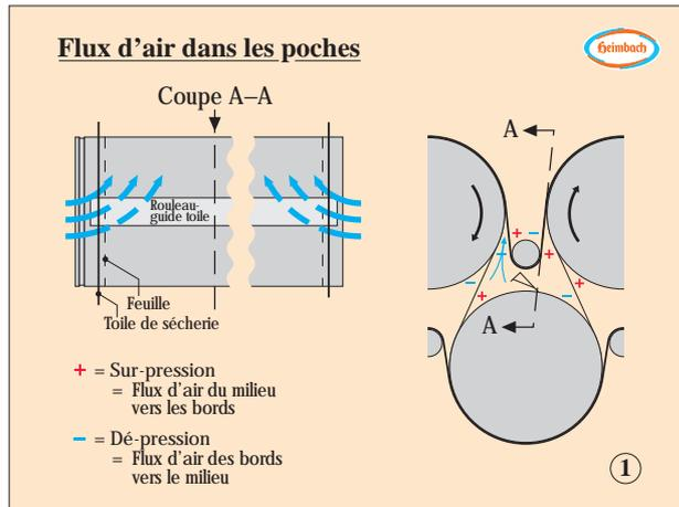
la zone de la hotte sur le CC et le CT suite à la dépression (fig. 1), s'enrichit en humidité au fur et à mesure qu'il migre vers le milieu de la machine. Par la suite, l'humidité absolue de l'air augmente.
