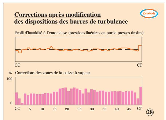
L'influence positive de cette manipulation est illustrée à nouveau très clairement sur la fig. 28: sous la forme de l'emploi équilibré de la caisse à vapeur avec des pressions linéaires homogènes dans les nips.
