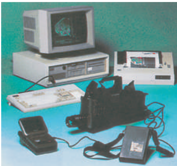
Fig. 1: équipement utilisé pour les mesures, l'analyse et la production des chiffres et images thermographiques
