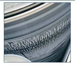
Les fibres, amidon et produits chimiques ont créé une couche isolante sur la surface du cylindre.
