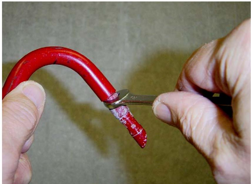
2. Nettoyez minutieusement la buse à l'aide d'une petite brosse et de l'eau. Vous pouvez utiliser de l'acide ou de la soude caustique pour enlever les dépôts de fibres, mais en temps court. Observer les instructions de sécurité lors de l'utilisation de soude ou acide !
