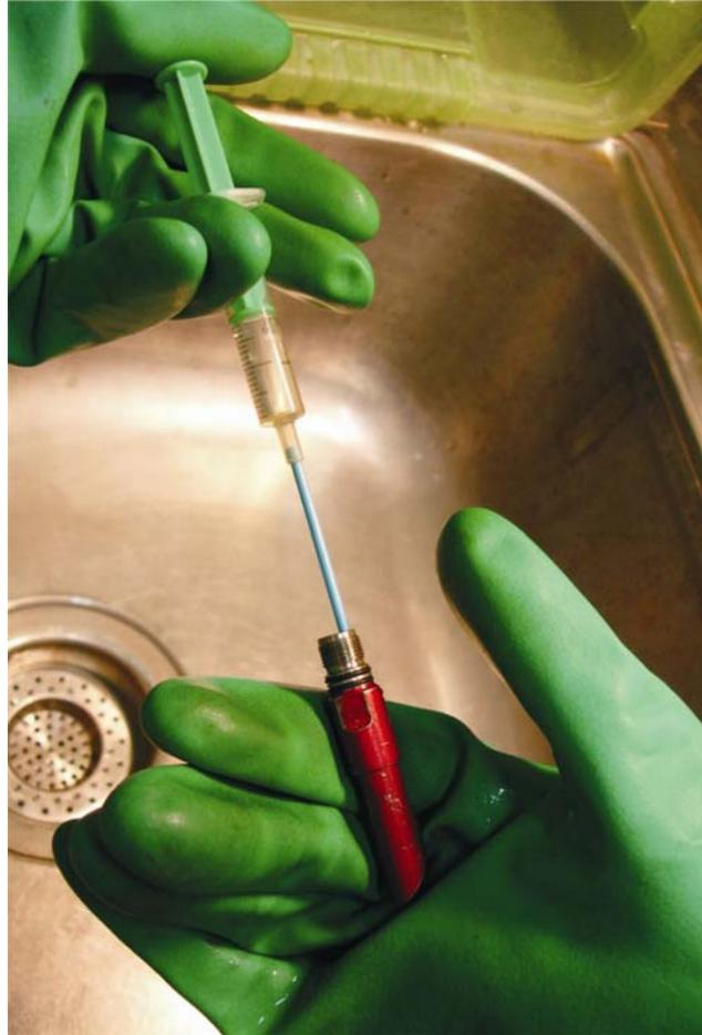
4. Utiliser une vieille buse à jet aiguille de 0,6 à 1 mm, connectée à un robinet d'eau par un tuyau flexible, pour rincer les buses après nettoyage à l'acide et être sûr que rien ne fuit vers l'extérieur. Regarder à l'intérieur de la buse pour s'assurer qu'elle est bien nettoyée.
