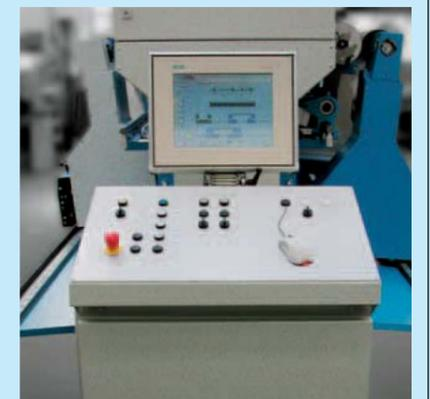
Console de l'opérateur avec panneau de commande tactile. Fonctionnement aisé pour l'opérateur et menus clairs permettent d'entrer facilement les données pour toutes les machines. Les informations sur la production sont stockées pour les actions répétitives.
