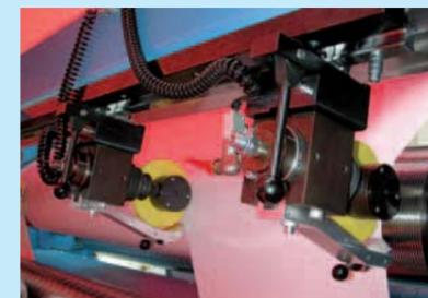
En fonction du matériau à transformer, la section de coupe est conçue pour une coupe cisaille tangentielle ou enveloppante, coupe par lames de rasoir, coupe par couteaux circulaires ou coupe en l'air, la combinaison d'unités de coupe est également possible. L'ajustement de la largeur de coupe peut être fait manuellement ou automatiquement.
