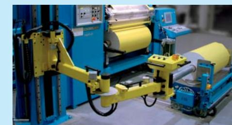
L'enlèvement de la bobine-fille peut être automatisé par des systèmes de manipulation d'arbre de bobineuse et des chariots de livraison. La mise sur palette peut être automatisée avec des robots.
