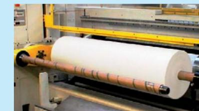
Les matériaux aux surfaces particulièrement sensibles peuvent être rebobinés avec des bobineuses sans contact.
