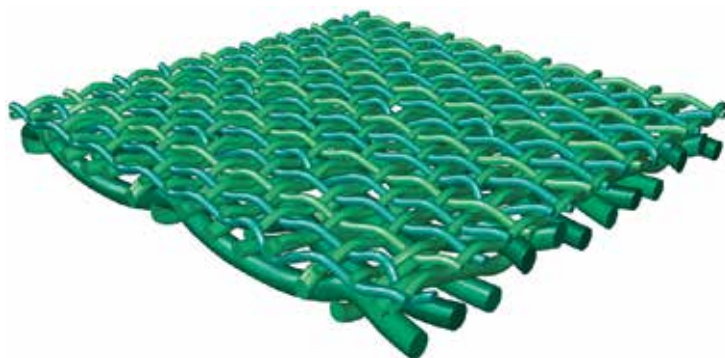
Primoselect en coupe: volume des pores réduit et épaisseur réduite.
